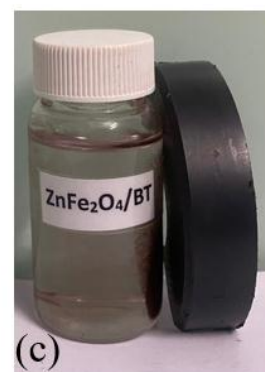
Hình 3.54. Đường cong từ trễ (a) của mẫu \text{ZnFe}_2\text{O}_4 (1), \text{ZnFe}_2\text{O}_4/\text{BT} (2) và hỗn hợp chứa \text{ZnFe}_2\text{O}_4/\text{BT} lúc ban đầu (b) và sau khi đặt nam châm 15 phút (c)
